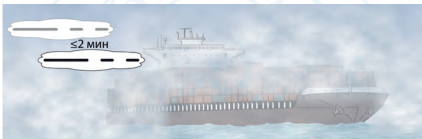
Судно, лишенное возможности управляться или ограниченное в возможности маневрировать, судно, стесненное своей осадкой, парусное судно, судно, занятое ловом рыбы, и судно, буксирующее или толкающее другое судно, либо судно, занятое ловом рыбы на якоре, и судно, ограниченное в возможности маневрировать, выполняющее свою работу на якоре (Правило 35 (c) (d))
