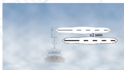
Лоцманское судно имеет ход относительно воды, когда оно находится при исполнении своих лоцманских обязанностей (Правило 35 (k))
