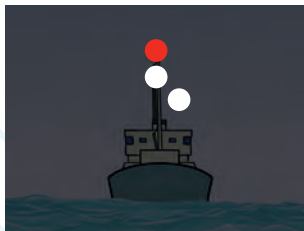
Вид с кормы, не имеет хода относительно воды
