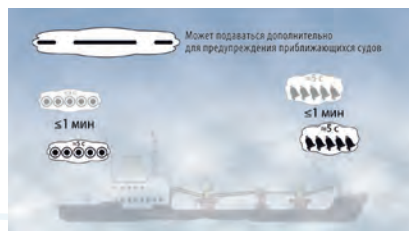
Судно длиной 100 м и более на якоре (Правило 35 (g))
