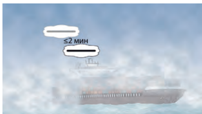
Судно с механическим двигателем, имеет ход относительно воды (Правило 35 (a))
