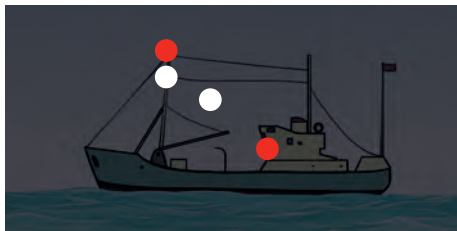
Вид с левого борта, имеет ход относительно воды
