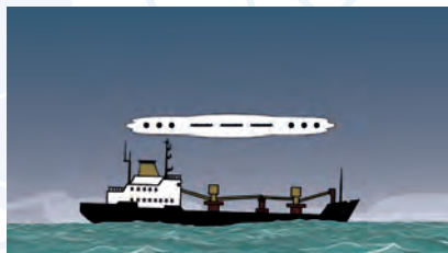
Сигнал, переданный с помощью любой сигнальной системы, состоящий из сочетания звуков SOS по азбуке Морзе
