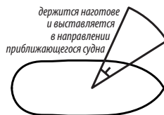
Схема расположения огней
