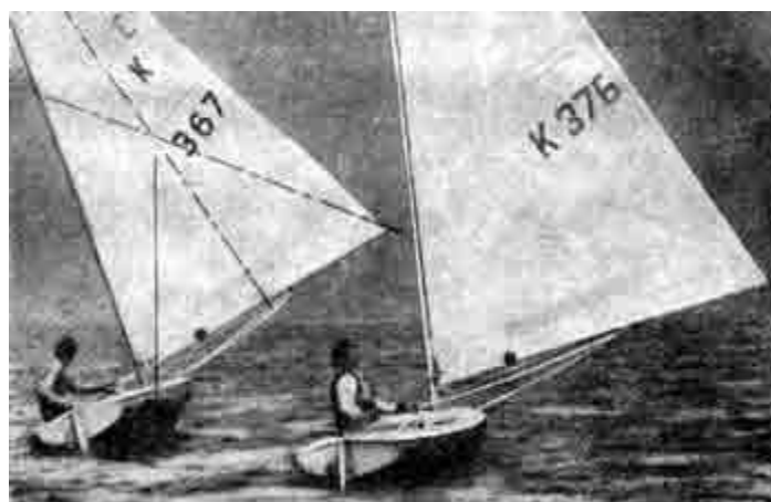
Рис. 18. Центр парусности “Финна” К367 находится практически над центром плавучести его корпуса.
