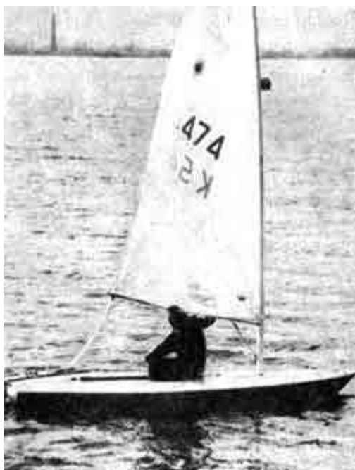
Рис.88. Когда грот вынесен на ветер, яхта начинает идти задним ходом, действие руля меняется на обратное. Каждый должен уметь управлять на заднем ходу
