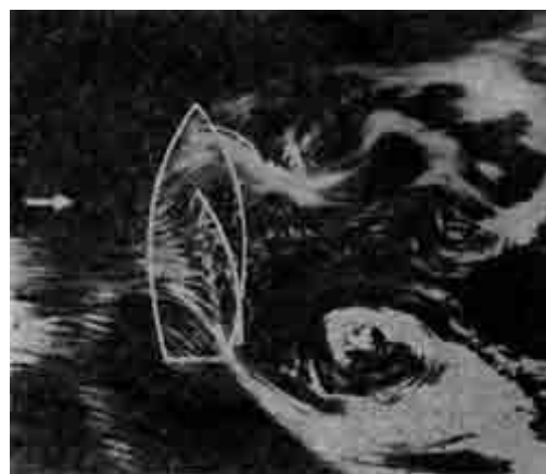
Рис. 14. Грот перебран, тяга уменьшилась, поперечная сила увеличилась, крен больше, скорость яхты меньше. Вихри под ветром очень интенсивны
