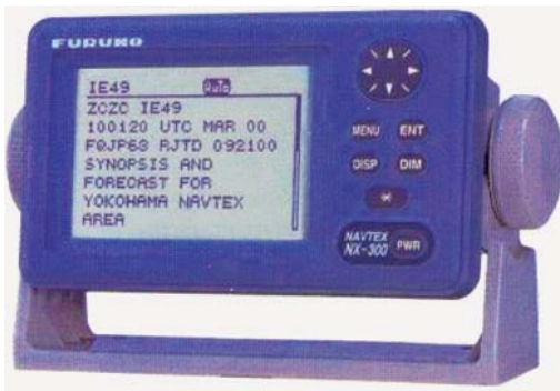
Рис.19 Приемоиндикатор NAVTEX NX-300 компании FURUNO.
