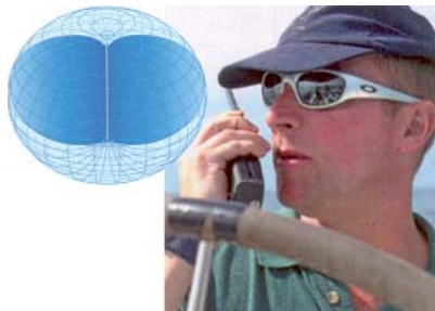
Рис.5 УКВ антенна портативной радиостанции наиболее близка по характеристикам к «изотропной» антенне. При своих 1.5 дБи она менее эффективно концентрирует мощность в конкретном направлении, но сравнительно нечувствительна к наклону. Это ее свойство весьма ценно для портативной радиостанции, которую тем не менее нужно стараться держать вертикально.
