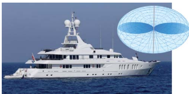
Рис.7 УКВ антенна моторного катера. 6 дБи антенна фокусирует в два раза больше мощности в горизонтальном направлении, чем 3 дБи антенна, или в четыре раза больше, чем «изотропная» антенна, но ее эффективность заметно падает при крене судна или установке под наклоном.
