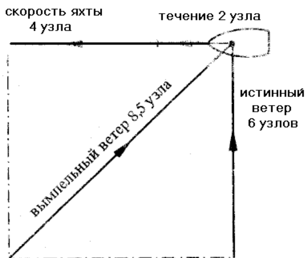
Рис. 17. Диаграмма вымпельного ветра при течения и движения яхты на истинном ветре поперек течения и курса яхты.
