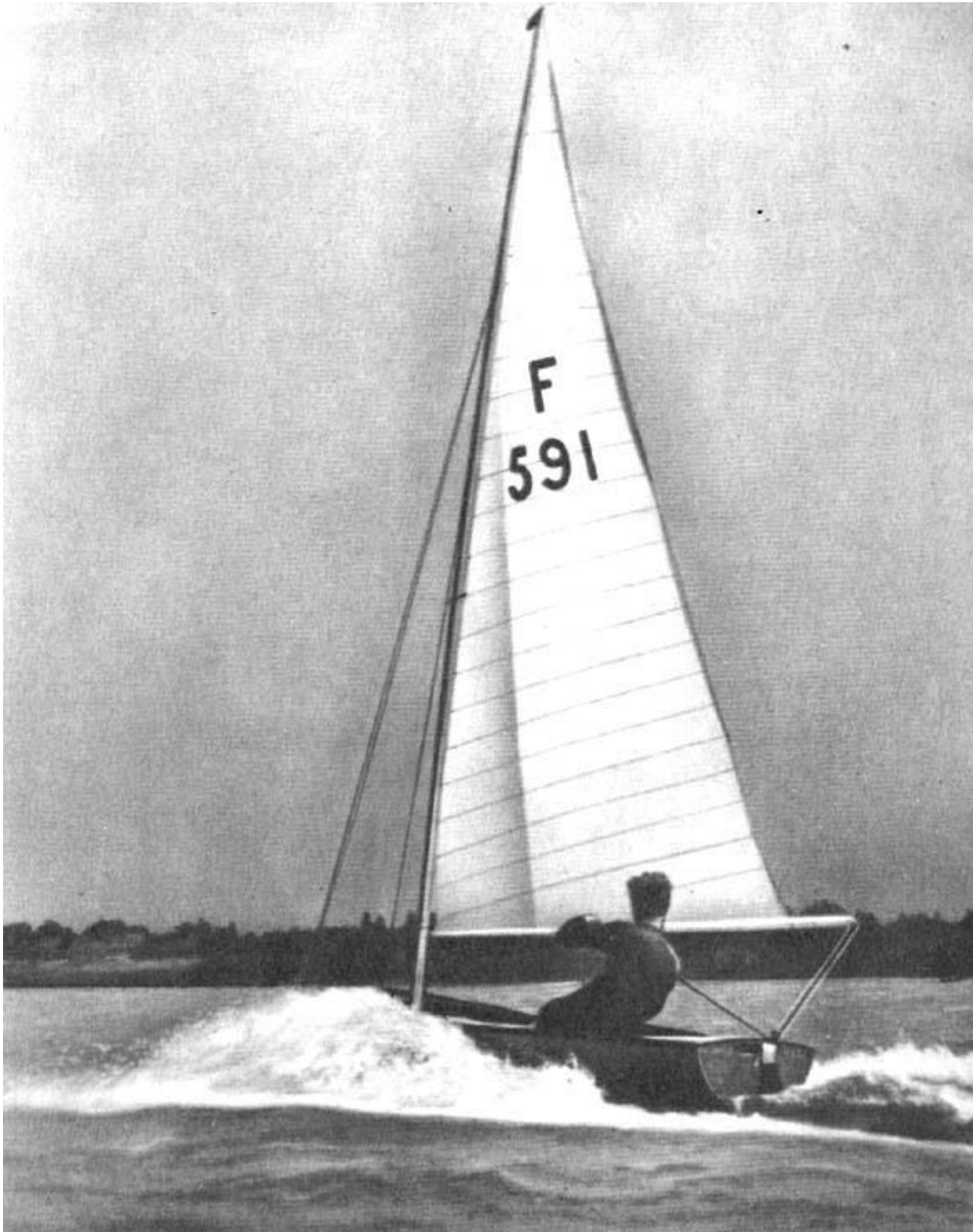
Фото 3. Эта фотография сделана через несколько секунд после предыдущей. Яхта глиссирует «а волне, рулевой переместил свой вес дальше к корме и одновременно выбрал гикашкот, подготовив парус к изменению направления вымпельного ветра из-за увеличившейся скорости. (Фото автора.)
