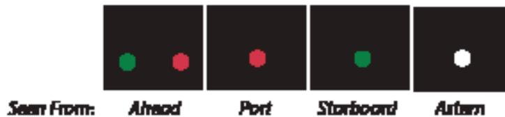
На парусном судне длиной менее 20 м (65 футов) бортовые и кормовой огни могут быть скомбинированы в одном фонаре, выставляемом на топе или около топа мачты на наиболее видном месте.
