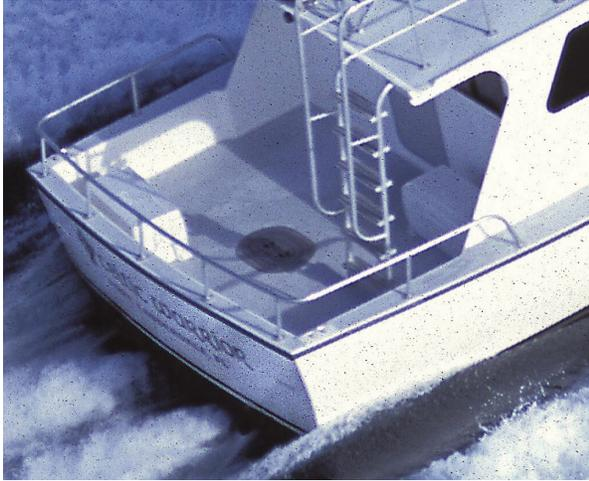
**Кокпит ("cockpit")** имеет дренажные сливы - шпигаты ("scupper") - в задней части судна.
