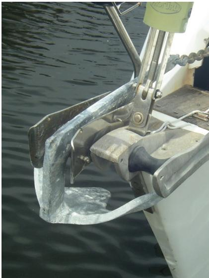
**Якорь ("anchor")** - приспособление для удержания судна на месте стоянки на открытой воде, соединяется с судном канатом или якорной цепью.
