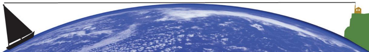
Ввиду кривизны земной поверхности, яхта с более высокой антенной имеет большее расстояние радиосвязи.
