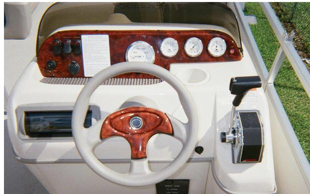
**Приборная панель ("console")** - штурвал, приборы и рычаг управления двигателем.
