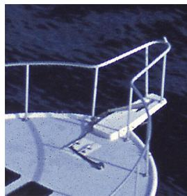
Релинг моторной лодки.
