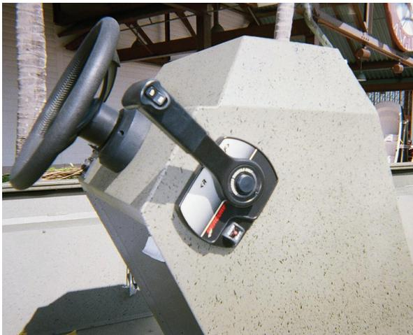
**Рычаг управления двигателем ("throttle control"/"transmission control")** - ручка управления двигателем и реверсом. Необходима для дачи переднего и заднего хода и увеличения оборотов винта.
