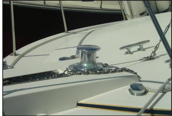
**Шпиль ("windlass")** - судовая лебедка с вертикальным барабаном, расположенная на баке, для отдачи и подъёма якоря.
