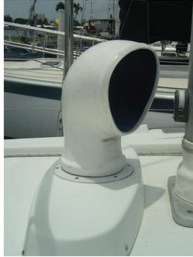
**Вентиляционные устройства** - съемные устройства, которые устанавливаются на палубе и проводят свежий воздух в нижние помещения. Они защищены от попадания воды. Используются как на парусных, так и на моторных лодках.
