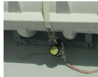
Устройство гидростатического выброса, прикрепленное к спасательному плоту
