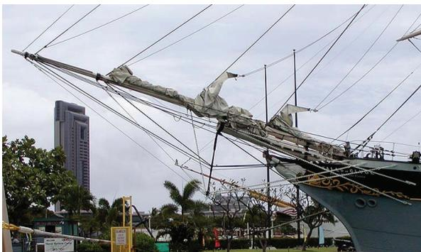
**Бушприт ("bowsprit")** - горизонтальная или наклонная штанга, выступающая с носа некоторых парусных лодок, позволяет устанавливать дополнительные паруса.
