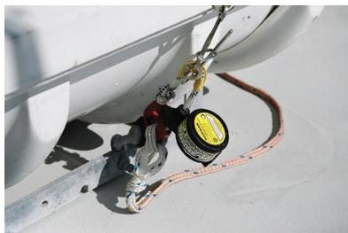
Устройство гидростатического выброса, прикрепленное к спасательному плоту
