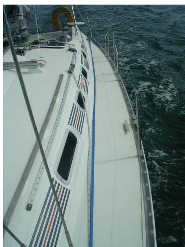
**Страховочный стальной трос или ремень ("jackstay")**, протянутый вдоль борта и закрепленный на носу и корме яхты, служит для закрепления карабина страховочной "сбруи".
