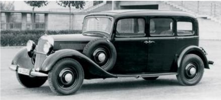
Первый серийный автомобиль с дизельным двигателем - Mercedes-Benz 260 (W170), 1935 г.
